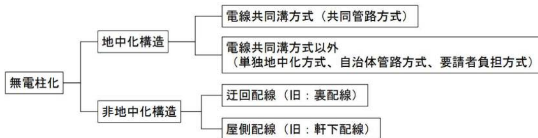
図 5-1 無電柱化の手法(出典:国土交通省 HP)
