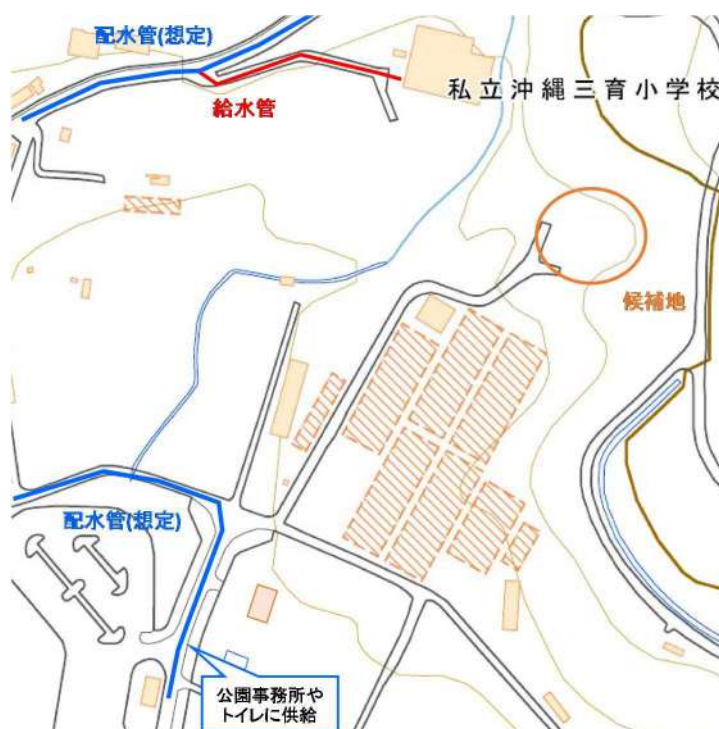
図 5-8 現状の配水管および給水管の想定
